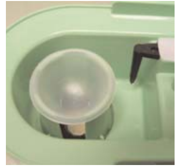
Figura 6. Ampolla del sistema de nebulización.
